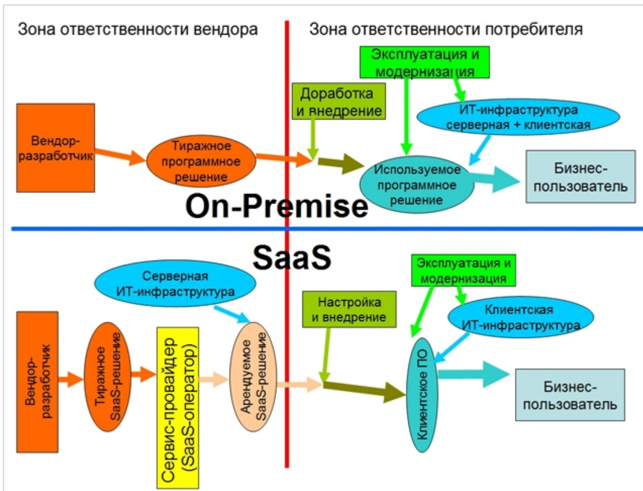
Рис. 2. Структурные схемы традиционной модели использования ПО и модели "ПО как услуга"
