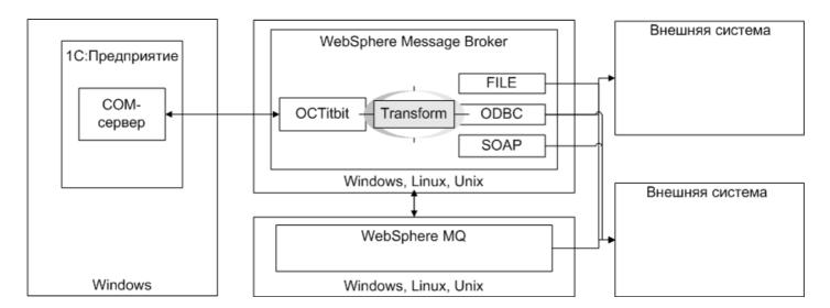
Решение многокомпонентное, при этом не привязанное к одному узлу в сети. Решение масштабируемое. Все это обеспечивается благодаря использованию ПО IBM WebSphere Message Broker.
